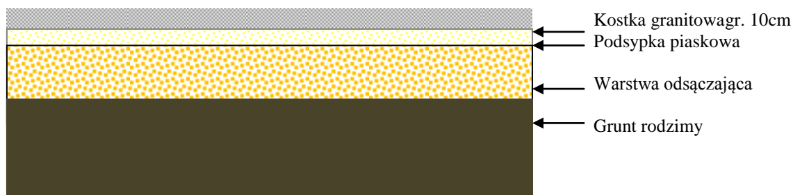
Nawierzchnia - przekrój
